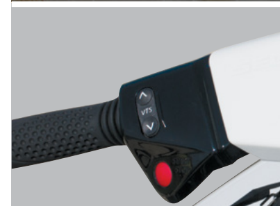
VTS™ (SISTEMA DE TRIM AJUSTÁVEL)
